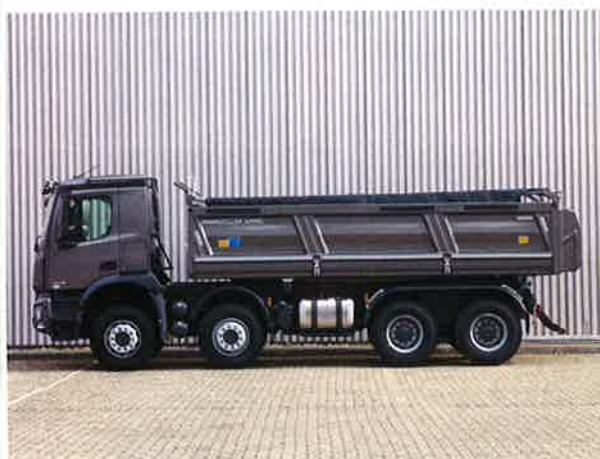
Gerade mal 3,17 Meter misst die Außenhöhe des Arocs mit neuem niedrigem Dach.
