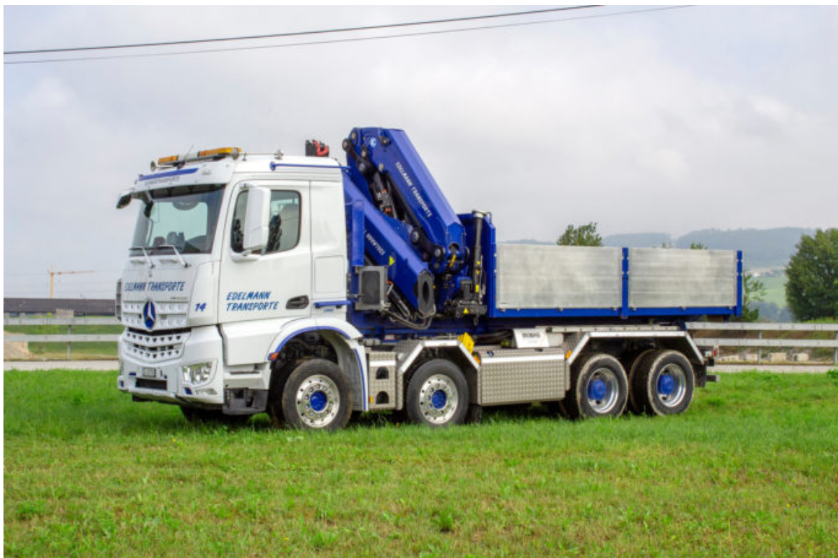
Einer der 15 neuen Arocs, die Edelmann Transporte anschafft. Dieses Exemplar verfügt über einen 510-PS-Motor, Powershift3 und High Performance Engine Brake.
